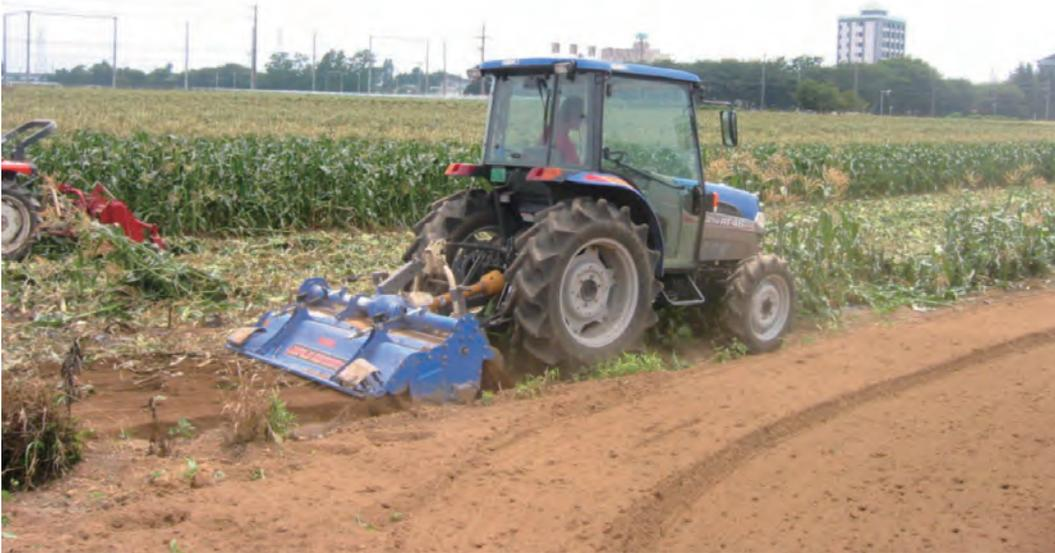
ポリマルチは根に絡んでしまうため外す手間が大変ですが、生分解性マルチは収穫した後の残茎と一緒にロータリーなどで圃場にすき込めます。
